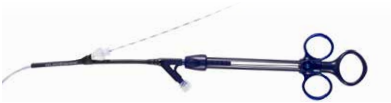
Steinextraktionskörbchen – 8 monofile Nitinol-Drähte Kompatibel mit Führungsdraht .035"; nicht geeignet für mechanische Lithotripsie
